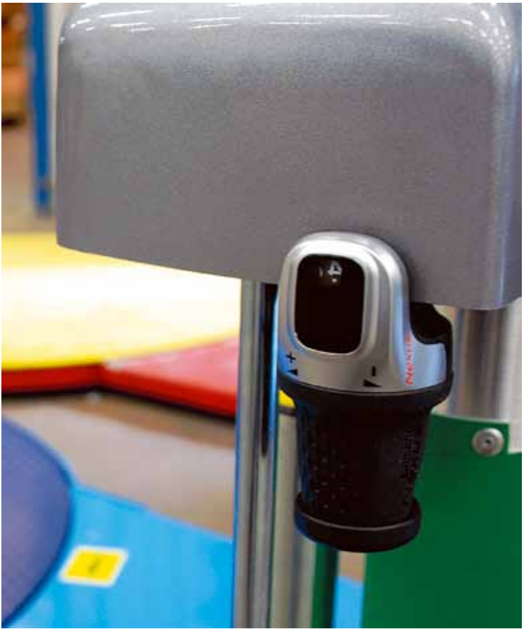
Utväxlingen regleras med hjälp av ett vred och en växel som används på cyklar.
